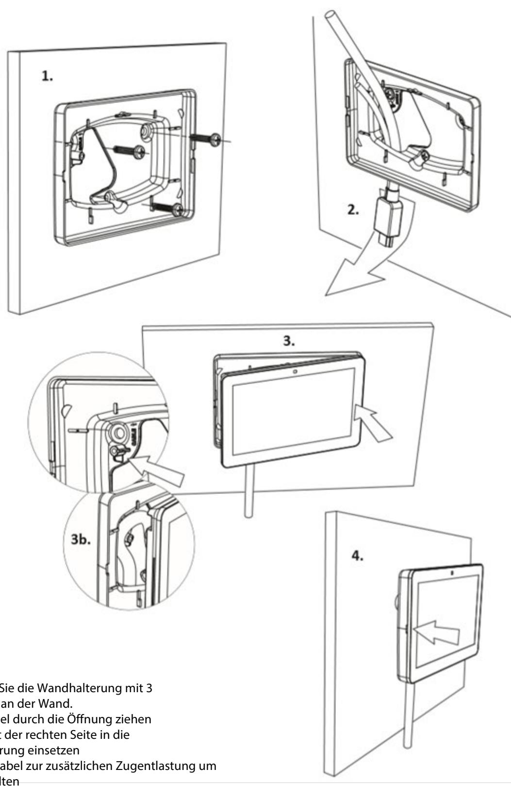
1. Montieren Sie die Wandhalterung mit 3 Schrauben an der Wand.
